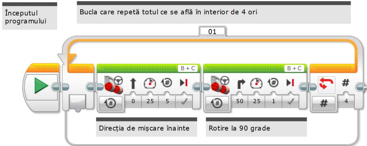
Figura 1.2 - Exemplu de program într-un limbaj grafic, care face robotul să se miște într-un pătrat
